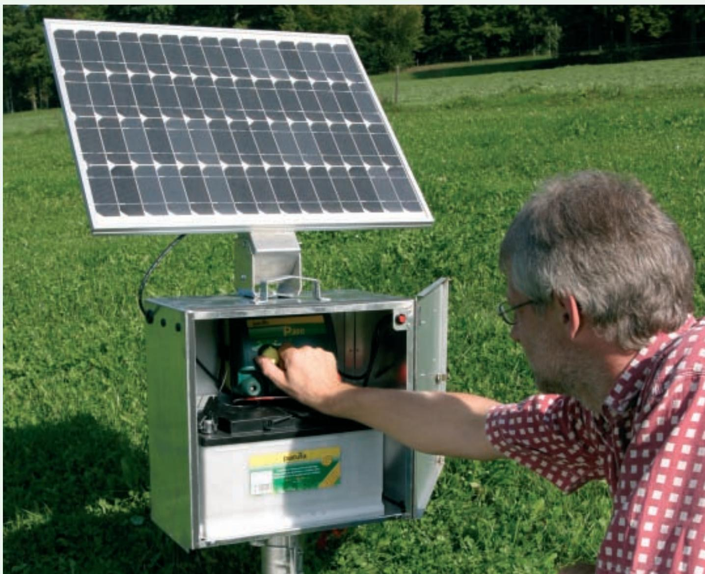
**Günter Herkert bei der Inbetriebnahme eines PATURA Elektrozaungerätes mit elektrifizierter Sicherheitsbox und Solarmodul.**
