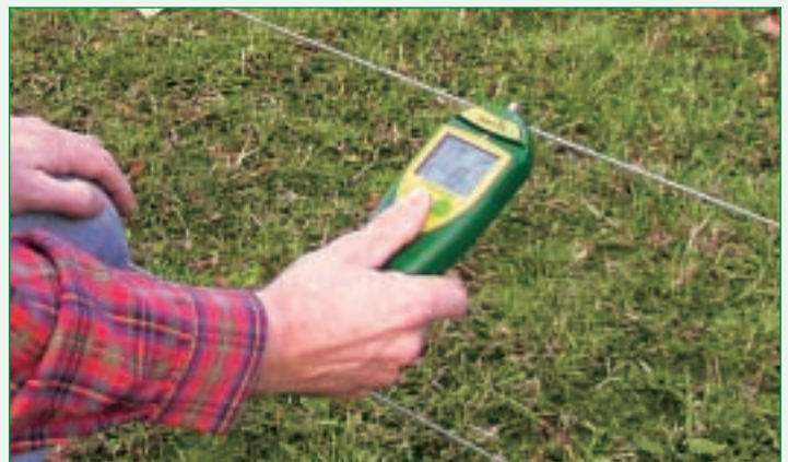
Die PATURA Fernbedienung wird auf den Zaundraht gedrückt und per Knopfdruck wird das Weidezaungerät zuhause ausgeschaltet - gleichzeitig wird die Zaunspannung und ggf. der Verluststrom gemessen.
