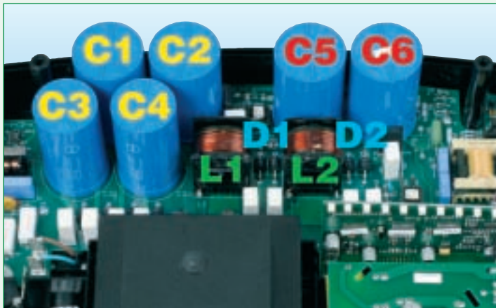
Typischer Aufbau des PATURA P8000 Gerätes mit MaxiPuls-Technologie: Lade-Kondensatoren C1 – C4, Impulsformungs-Kondensatoren C5 – C6, Impulsformungsspulen L1 – L2, Impulsformungsdioden D1 – D2; die hochwertigen Bauteile C5 – C6, L1 – L2 und D1 – D2 dienen ausschließlich der Erzeugung der optimalen Impulsform und sind in herkömmlichen Weidezaungeräten in dieser Form nicht vorhanden.
