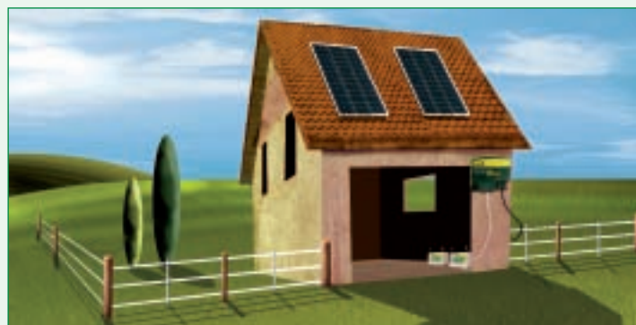
Ideal für den zuverlässigen Betrieb ist die feste Installation des P800 mit den Akkus in einer Hütte und den auf dem Dach montierten Solarmodulen.
