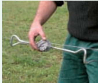
Spannbügel in den Draht einhängen, Sicherungsbügel einsetzen und Spannbügel entnehmen
