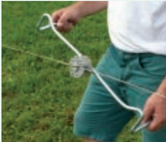
Spanner in den Draht einlegen, Spannbügel einsetzen
