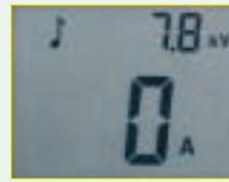
Anzeige der Spannung (7,8 kV = 7800 Volt)
