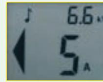
Anzeige von Spannung (6,6 kV = 6600 Volt), Stromstärke (5 Ampere) und Stromrichtung (nach links)
