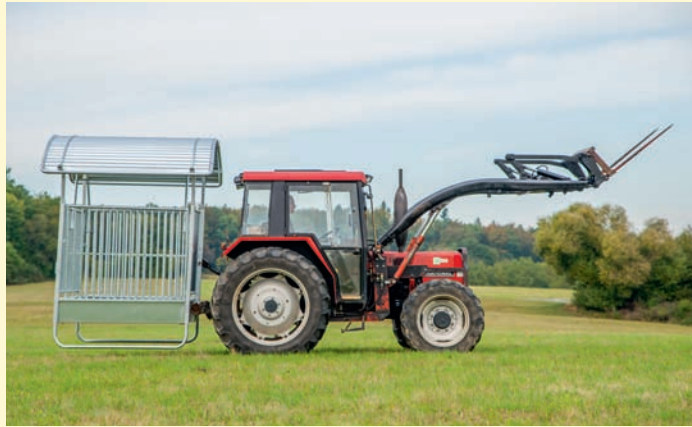
Transport über Schlepperdreipunkt, ungefüllt mit max. 10 km/h
