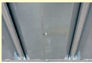
Doppelte Verstärkungsrohre unter dem Bodenblech
