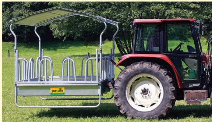
Transport über Schlepperdreipunkt, ungefüllt mit max. 10 km/h
